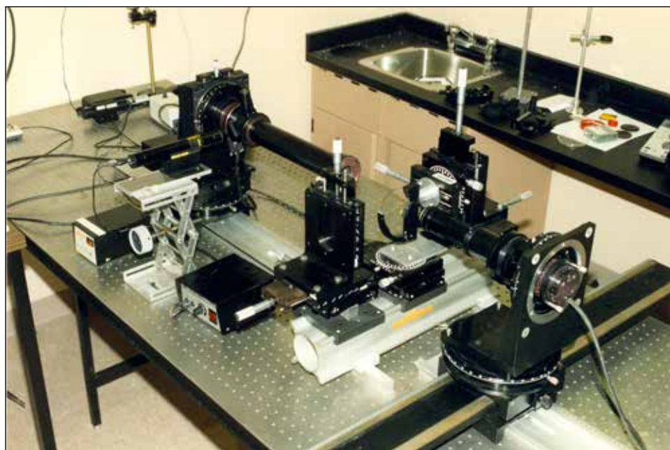
Figure 3. De l'équipement dont se dote l'École d'optométrie : un dispositif servant à évaluer la qualité optique des verres ophtalmiques et des systèmes optiques par la mesure de leur fonction de transfert de modulation
